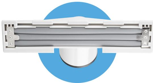
Las láminas de goma del **Vibra-Tool** golpean el colchón aproximadamente 40 veces por segundo. Estas vibraciones desprenden la suciedad, el polvo y los ácaros de las fibras textiles que posteriormente son extraídas por la succión de la aspiradora.
