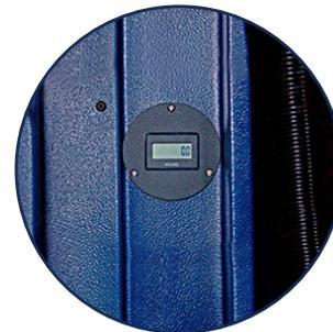
El medidor de tiempo de ejecución rastrea cuántos Horas que la máquina ha funcionado.
